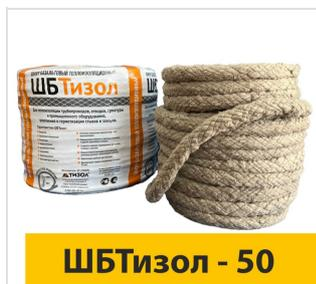
Шнур базальтовый теплоизоляционный представляет собой сетчатую оплетку из стеклянной или базальтовой нити, наполненную холстом из базальтового супертонкого волокна.
